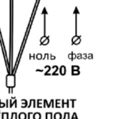
элемента кабельного тёплого пола подключается к клемме 5 или к заземлению (при наличии заземляющего контура).
