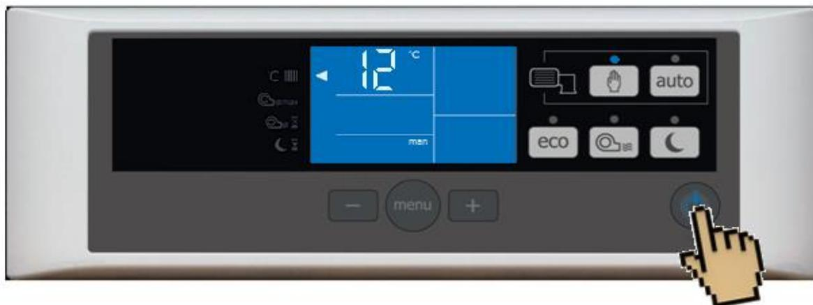
Во время первого розжига Вы можете использовать ручной режим включения вентилятора. Нажав кнопку ручного режима включения вентилятора, Вы установите скорость надува воздуха на минимальный уровень для стимулирования розжига.
