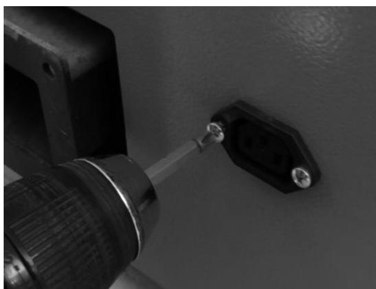
9. Вставьте 4 крепления М6 х 20 в отверстия входного адаптера вентилятора, находящегося слева. Укрепите на них одну керамическую прокладку. Установите вентилятор как показано на рисунке и закрепите его при помощи 4 болтов М6. Вставьте штепсель вентилятора в розетку, находящуюся на левой боковой панели:
